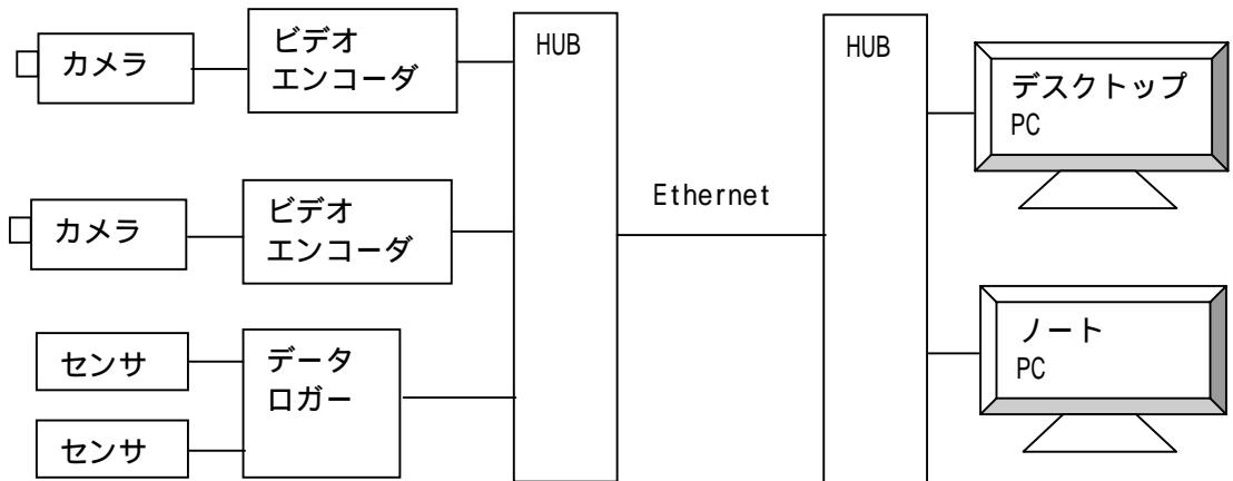
カメラやデータロガーが多数存在する場合や増設時、各機器に対する Ethernet 信号ケーブルをハブに接続するだけで済む。カメラに接続するビデオエンコーダやシリアル Ethernet変換機器等が必要となる分、個別機器のコストが高くなる。
